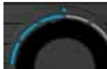
I läget "Humidifier" (Luftfuktning) lyser LED-lamporna blått
