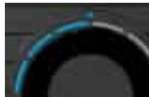
No modo "Humidifier" (Humidificação), os LEDs acendem a azul
