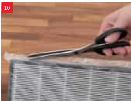
Fjern A681 HYBRID-filterets beskyttelseshylster.
