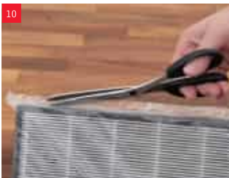
10 Verwijder de beschermfolie van het HYBRID-filter A681.
